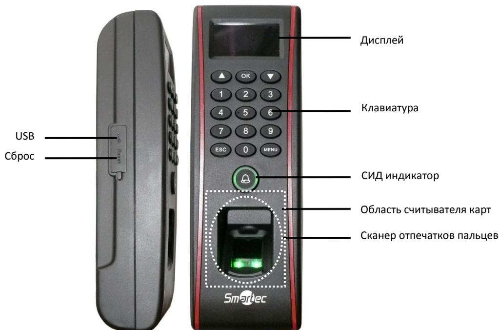
**СИД индикатор** используется для отображения результата выполняемых операций и состояний считывателя.
