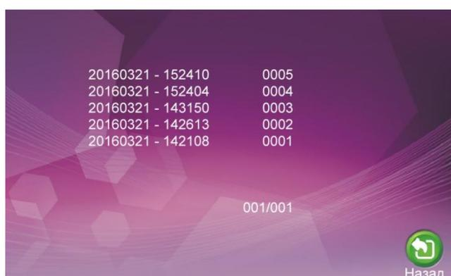
С помощью кнопок + - или, используя отклонения поворотного переключателя вверх или вниз, выберите требуемый файл, для просмотра еще раз нажмите кнопку **Настройка** или поворотный переключатель.
