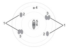
Эффекты интерференции от дневного и искусственного освещения фильтруются оптическим фильтром дневного света, электронным способом и при помощи синфазного выпрямления (устойчивость к внешнему освещению: тест на яркость DIN EN 54-7).
