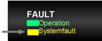
**Индикатор System fault (Системный сбой) (желтый) — аварийный режим**
