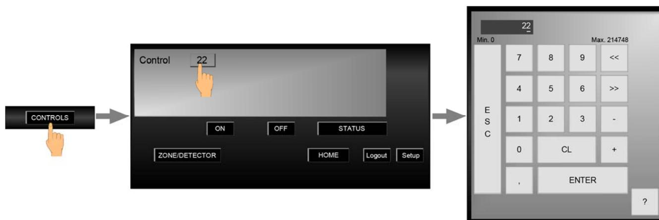
Рис. 23. Включение/сброс управляющего элемента 22 (пример)
