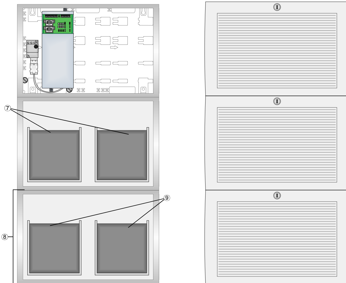
Рис. 14: PSU extension 24 V / 24 Ah (Арт. № FX808364) incl. optionally available components
