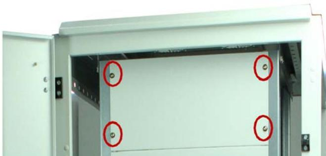
Закрепите заглушку на ранее установленных закладных гайках (4 шт. М6 x 12 мм)
