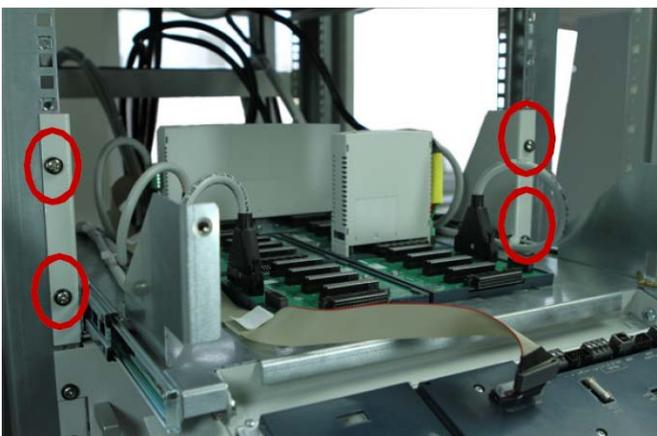
Вставьте полозья ящика в ранее установленные направляющие и закрепите ящик 4 винтами (М6 x 12 мм) с лицевой стороны.
