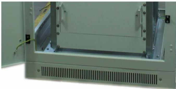
Последней по порядку монтируется нижняя панель-заглушка 2НУ. Закрепите заглушку на ранее установленных закладных гайках (4 шт. М6 x 12 мм)
