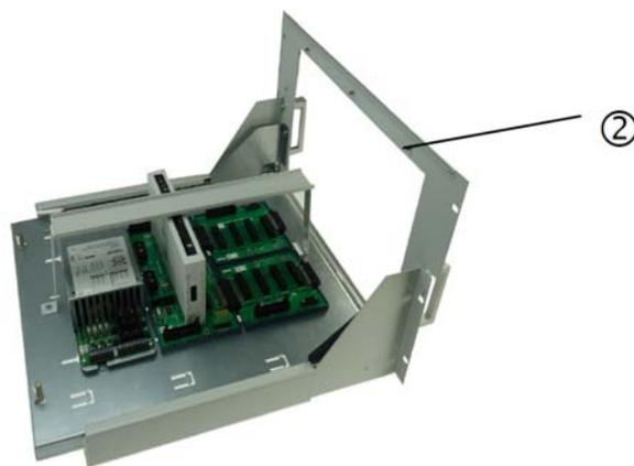
Рис. 15: Выдвижной ящик с лицевой панелью 7НУ без установленного пульта управления
