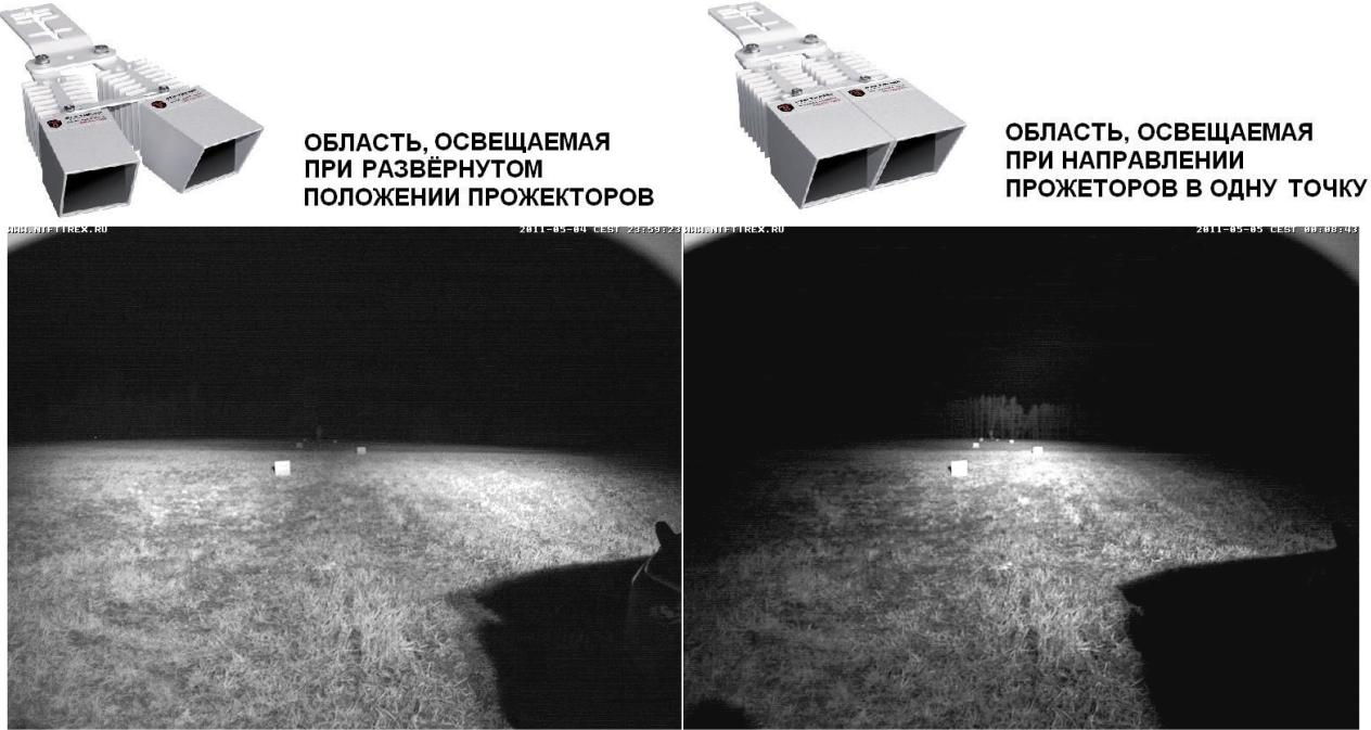
**На фото: ПИК 200-10.** Камера Mobotix M12, 1/30 сек. (0.1ЛК), объектив 20 градусов.
