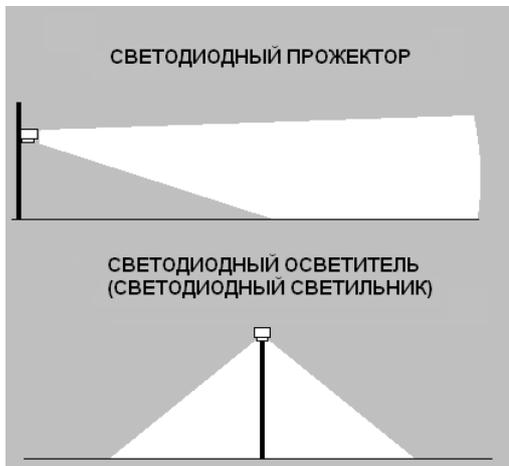
**Светодиодные прожекторы** серии ПИК имеют узкий угол излучения, сформированный вторичной концентрирующей оптикой и предназначены для освещения полосы вдоль охраняемого периметра. Луч прожектора идёт параллельно поверхности земли, при этом достигаются высокие значения дальности работы, т.е. уровни освещённости достаточны для идентификации объектов на предельных дистанциях.
