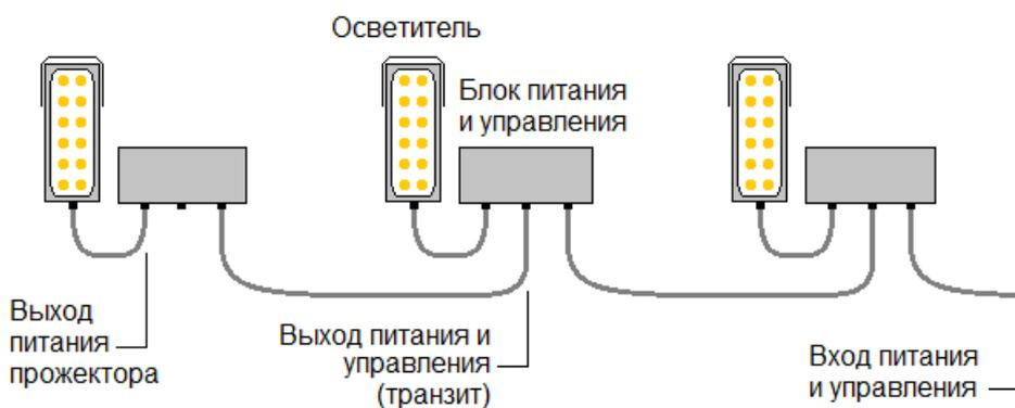
**ВНИМАНИЕ:** При заземлении транзитный кабель должен быть 4-х жильным, максимальным диаметром на более 10 мм.
