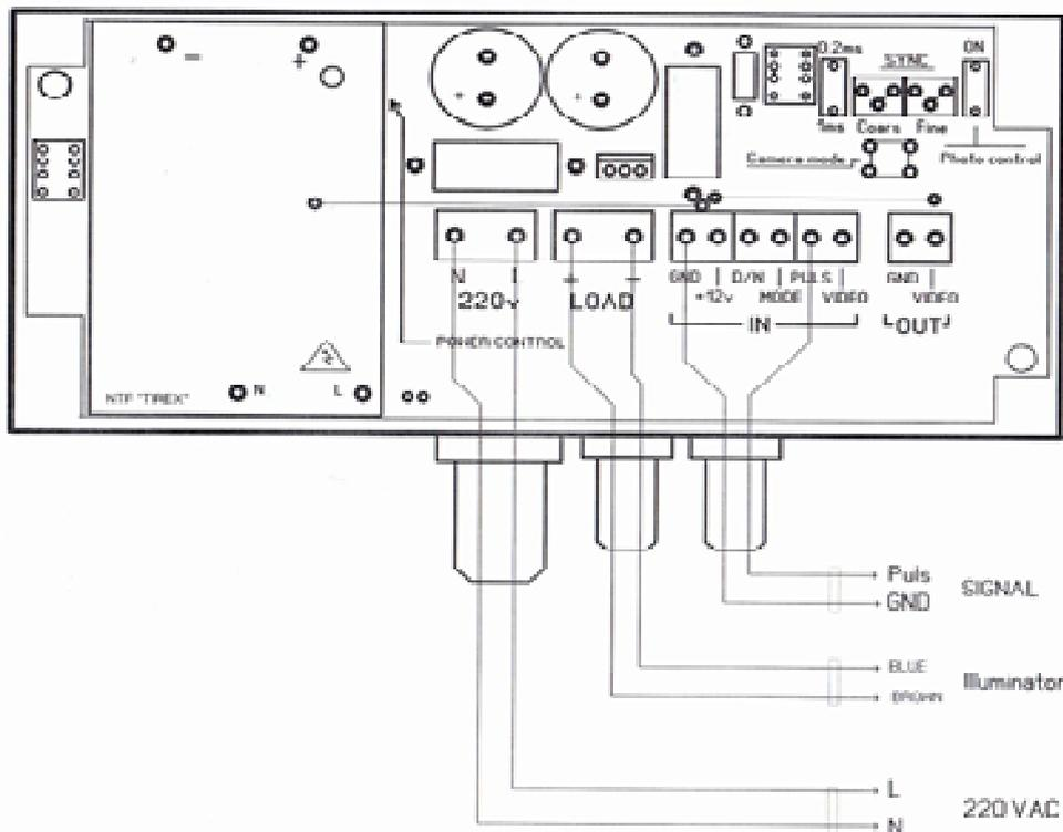
**Power control** – потенциометр; регулировка яркости (мощности излучения)
