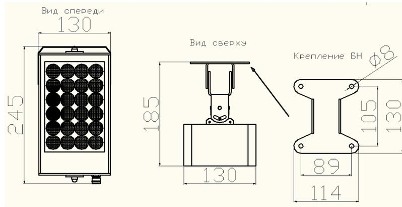
Серия светодиодных узкоградусных прожекторов с большим световым потоком, разработанная специально для применения в системах охраны - освещения периметров, контрольно - следовых полос (КСП), территории социально - значимых объектов, объектов нефтегазовой отрасли, атомной энергетики и др. Светотехнические параметры приборов позволяют вести как визуальное, так и видео наблюдение на охраняемом объекте.
