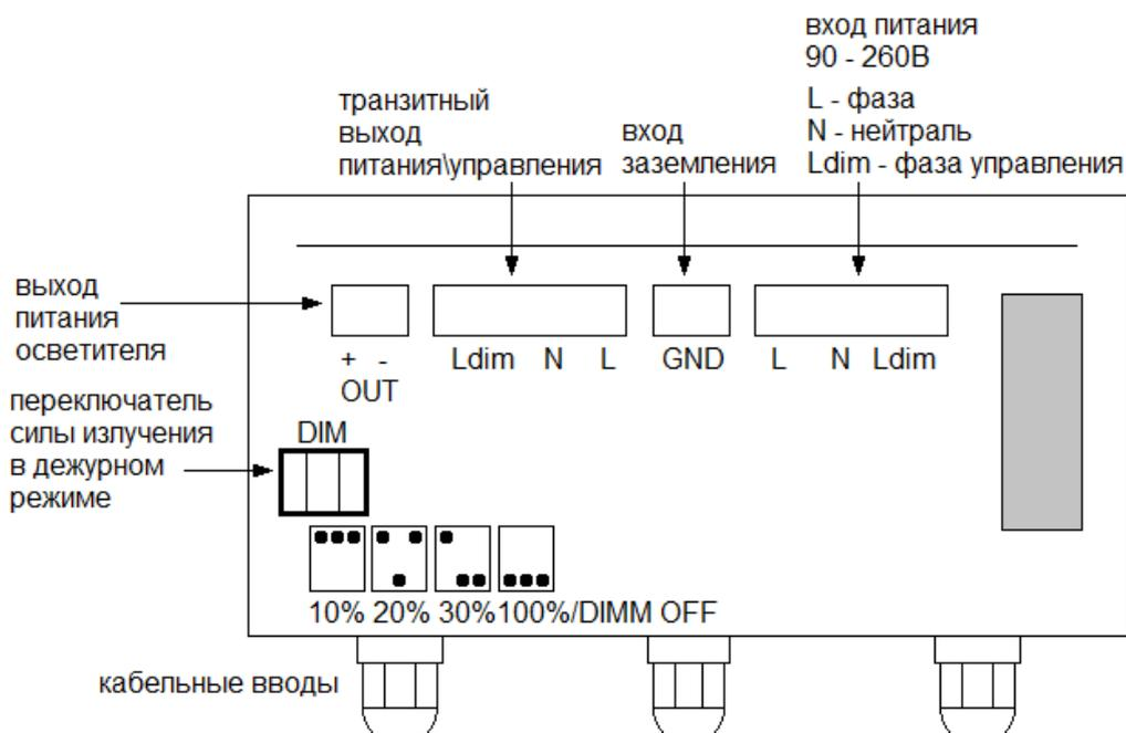
Схема параллельного соединения осветителей с использованием транзитного кабеля питания и управления
