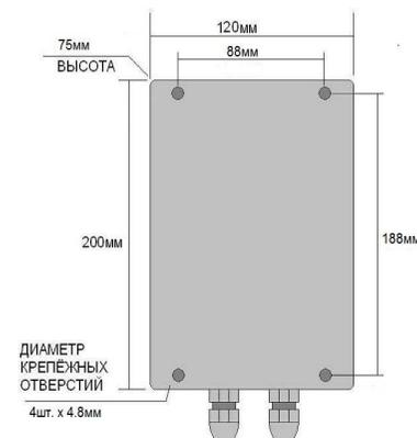
Гермоводы под сетевой кабель наружного диаметра max Ø 8мм
