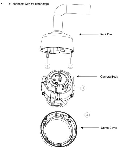
FIGURE 2-8: INDOOR / OUTDOOR PENDANT ALIGNING
