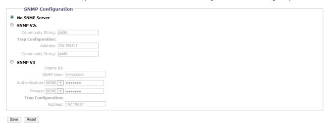
FIGURE 3-19: SNMP CONFIGURATION
