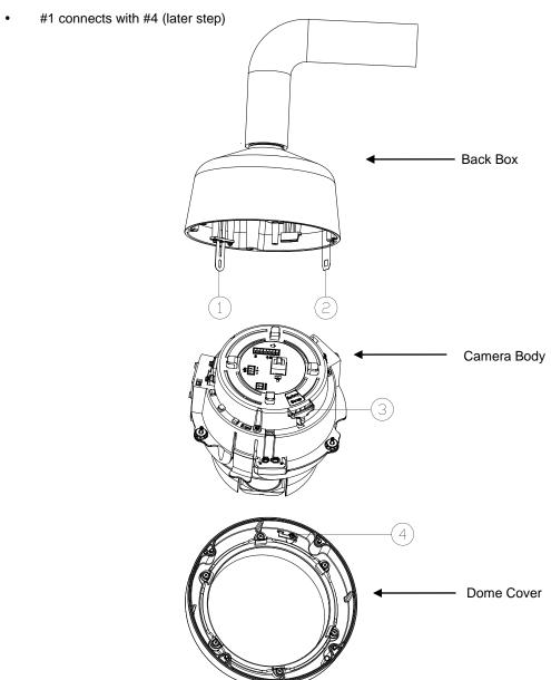
FIGURE 2-4: INDOOR / OUTDOOR PENDANT ALIGNING
