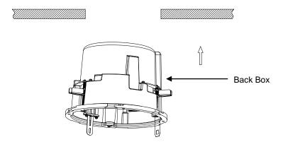
FIGURE 2-11: INSERTING THE BACK BOX
