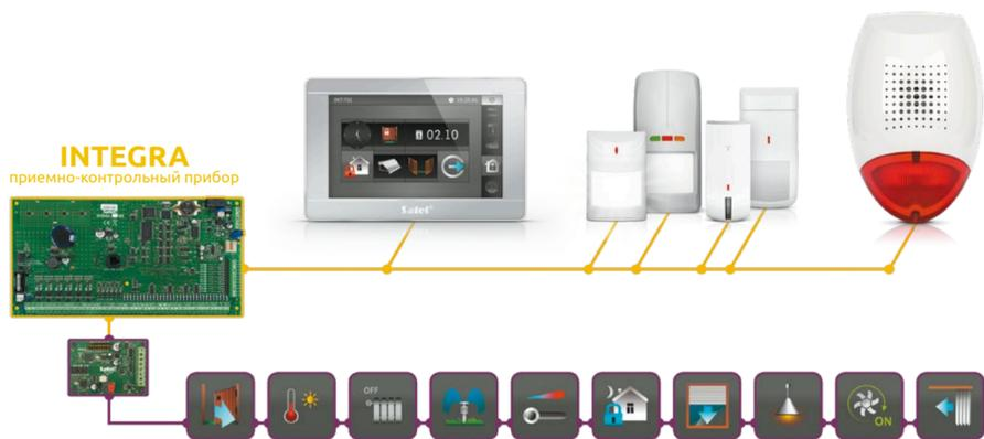
Модуль INT-KNX-2 позволяет совместить возможности систем, построенных на базе ПКП INTEGRA с функциональностью систем управления домашней автоматикой KNX. Такое сочетание **позволяет управлять устройствами KNX с помощью системы INTEGRA**, а также получать от ПКП INTEGRA информацию о состоянии устройств KNX. Преимущества, связанные с использованием INT-KNX-2 – это, прежде всего, расширение возможностей обеих систем за счет эффекта синергии, а также понижение расходов, связанных с установкой.
